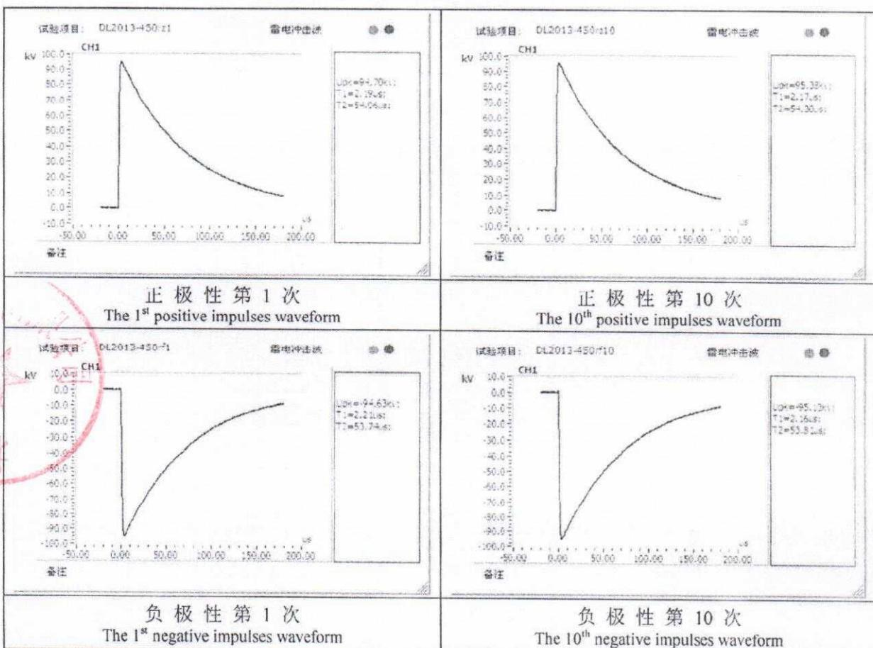
附录C 恒压负荷循环试验后组合试样冲击电压试验实际耐受电压值和冲击电压波形(室温下, 95 kV, 允许  $\pm 3\%$  偏差)
